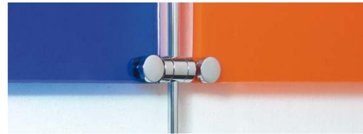
**IT** morsetto laterale doppio e regolabile per pannelli su astine. il fissaggio all'astina e al pannello avviene tramite brugole. le parti finali del morsetto sono regolabili per il fissaggio orizzontale, verticale o obliquo dei pannelli. fissaggio: morsetto laterale doppio per pannelli, girevole. materiale: ottone cromato. spessore del panello: 0-10mm, spessori maggiori con brugole più lunghe. spessore dell'astina: Ø6mm.
