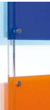
**IT** morsetto frontale per pannelli su astine. il fissaggio all'astina e al pannello avviene tramite brugole. testina decorativa con forellino laterale per facilitare il montaggio. foro pannello: Ø4mm. astina: Ø6mm.
