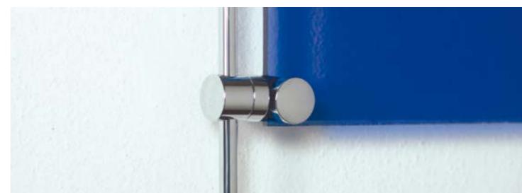
**IT** morsetto laterale regolabile per pannelli su astine. il fissaggio all'astina e al pannello avviene tramite brugole. la parte finale del morsetto è regolabile per il fissaggio orizzontale, verticale o obliquo del pannello. fissaggio: morsetto laterale per pannelli, girevole. materiale: ottone cromato. spessore del pannello: 0-10mm, spessori maggiori con brugole più lunghe. spessore dell'astina: Ø6mm.
