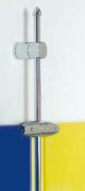
**IT** morsetto a parete per astine. per il fissaggio di astine a soffitto o a parete. fissare la base, inserire l'astina nel morsetto, assicurare morsetto e astina con brugola. ideale per il premontaggio. spessore dell'astina: Ø6mm.
