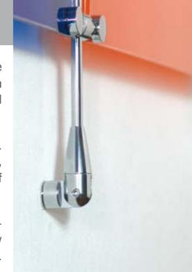
**IT** tirante snodabile di 180° per astine. fissare il tirante a soffitto oppure a parete, inserire la barra nel cono e la brugola all'estremità dell'astina, avvitare barra e cono al tirante. spessore dell'astina: Ø6mm.
