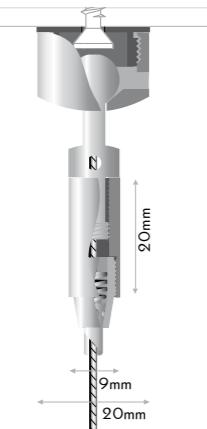
**IT** tirante snodabile per cavi, sistema variabile. montare il tirante ed inserire il cavo: il sistema di autobloccaggio lo trattiene automaticamente. la tensione del cavo si regola avvitando la parte snodabile del tirante. spessore del cavo: max. Ø1,2mm.
