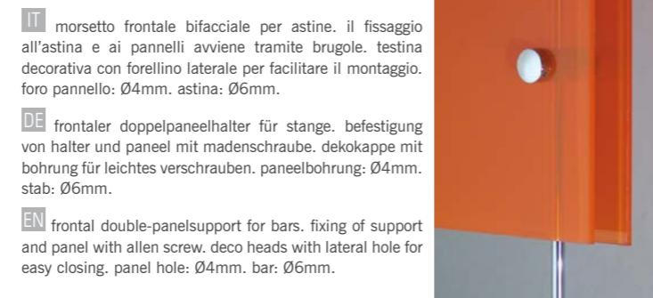
**IT** morsetto frontale bifacciale per astine. il fissaggio all'astina e ai pannelli avviene tramite brugole. testina decorativa con forellino laterale per facilitare il montaggio. foro pannello: Ø4mm. astina: Ø6mm.
