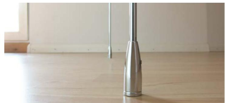
**IT** base di appoggio regolabile per astine. inserire l'astina nella base e fissarla con la brugola laterale. grazie alla regolabilità data dall'avvitamento si può scegliere la lunghezza desiderata, si possono eliminare piccole irregolarità del pavimento e l'astina viene tenuta perfettamente in tensione. spess. astina: Ø6mm.
