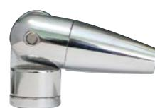
**IT** connettore snodabile di astine. utilizzabile per il fissaggio a parete e come connettore per 2 astine. il giunto, ruotabile di 180°, permette di montare le astine non solo ad angolo retto ma anche in altre direzioni. agganciare le due parti di arte alle astine, mettere la brugola all'estremità delle astine e avvitare per collegarle. spessore dell'astina: Ø6mm.
