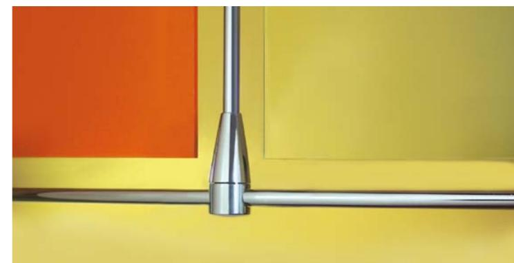
**IT** connettore a T per 2 astine. inserire un'astina nel foro alla base del cono e l'altra perpendicolarmente all'estremità a punta di tripla. effettuare il fissaggio con la brugola. per connessioni semplici di due astine. spessore dell'astina: Ø6mm
