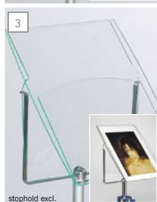
3 stopup portaposter a tasca in acrilico color vetro, spessore 3mm, per formato DIN A4, inclinato di 45°, inserimento del foglio laterale. stopup acrylglas-posterhalter 3mm stark für ein einzelblatt im DIN A4 format, 45° neigung, seitlicher einschub. stopup glassgreen acrylic poster holder, thickness 3mm, for one single sheet in DIN A4 format, inclination 45°, insertion sideways.
